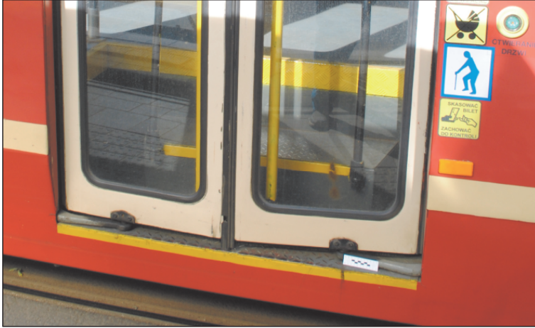
Ryc. 3. Niedomykające się drzwi wagonu stwierdzone w czasie oględzin tramwaju.
