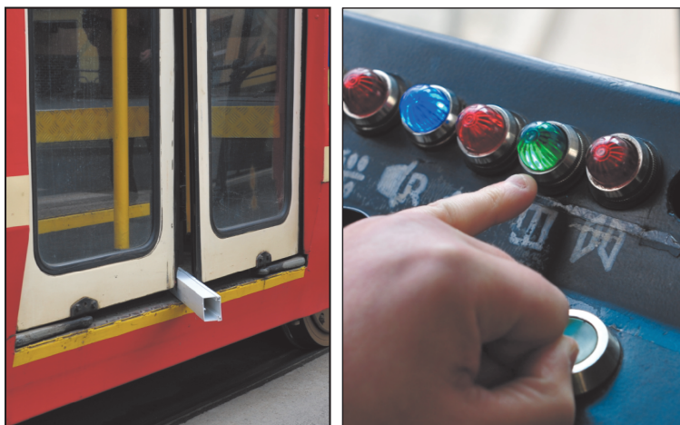
Ryc. 6. Klocek o szerokości 40 mm włożony pomiędzy skrzydła drzwi tramwaju i kontrolka sygnalizująca zamknięcie drzwi.
