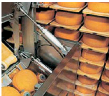
Rysunek 1. Siłownik pneumatyczny do prasowania serów żółtych Figure 1. Air cylinder for pressing cheese
