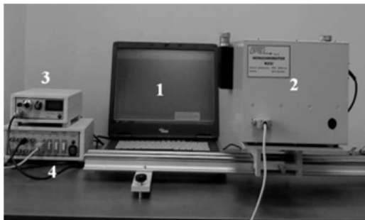
Rys. 4. Spektrometr VIS-NIR: 1 - komputer, 2 - monochromator, 3 - wzmacniacz, 4 - sterownik Fig. 4. Spectrometer VIS-NIR: 1 - computer, 2 - monochromator, 3 - amplifier, 4 - driver
