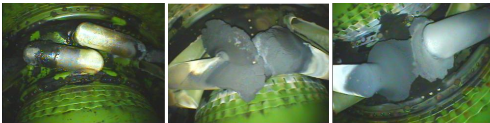
Rys. 7 Fotografie parownic: przed badaniem (rys. lewy), po 20 h próby na paliwie Jet A-1 (rys. środkowy) i po 20 h próby na paliwie BioJet 10% (rys. prawy)
