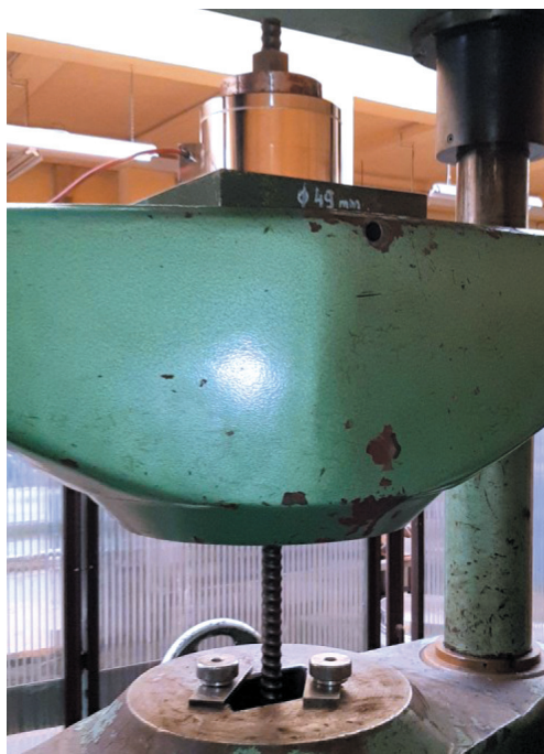
Rys. 12. Żerdź kotwi zamocowana w pulsacyjnej maszynie wytrzymałościowej
