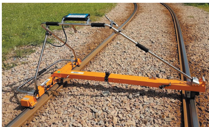
Rys. 2. Samorejestrujący toromierz elektroniczny TEC-1453 N3 Źródło: opracowanie własne
