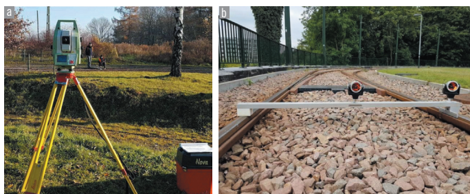
Rys. 1. Tachymetr Leica Nova MS50 (a) oraz belka pomiarowa Goecke Schwelm (b) Źródło: opracowanie własne
