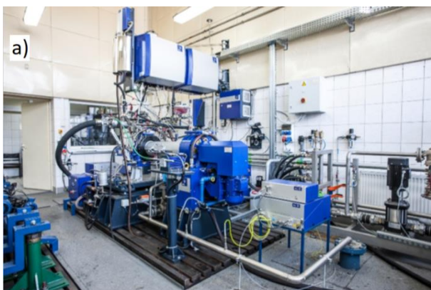
Rys. 2. Hamownia silnikowa firmy AVL, widok stanowiska badawczego
