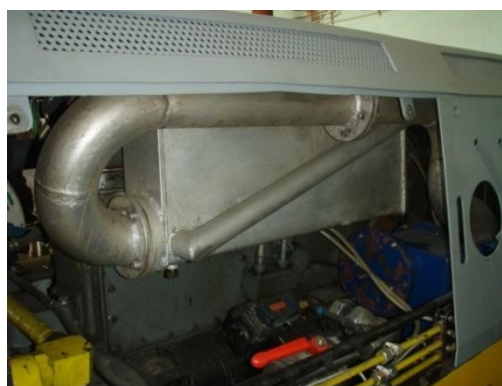
Rys. 7. Kolektor wylotowy chłodzony wodą [5]
