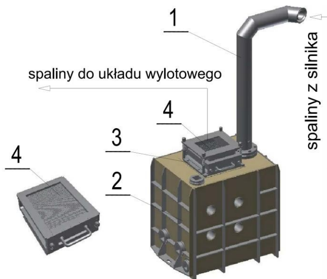
Rys. 10. Płuczka wodna spalin z przerywaczem [opracowanie własne]
