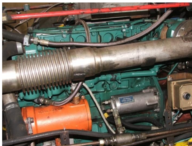
Rys. 13. Przewód wylotu spalin z płaszczem wodnym [opracowanie własne]
