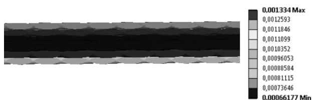
Rys. 9. Odształcenie termiczne przewodu AFL-6 240 mm 2 dla odwzorowania dokładnego
