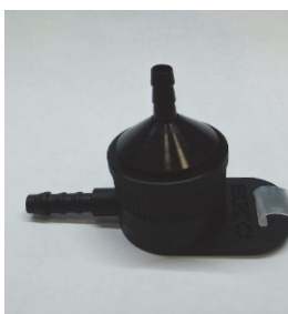
Rys. 2. Próbnik IOM z nasadką kalibracyjną Fig. 2. IOM sampler with calibration cap
