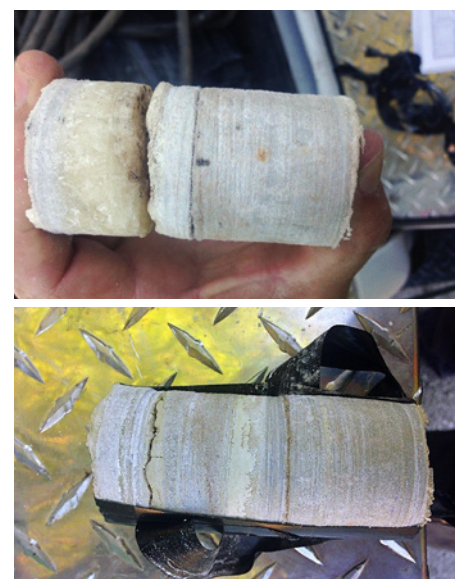
Ryc. 13. Próbk rdzeniowe z uszkodzonej części
