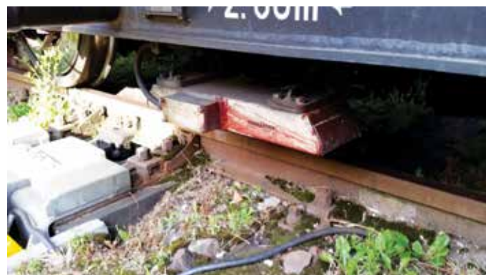
Fot. 1. Szczątki biologiczne na elementach podwozia taboru kolejowego. Fot. Koleje Wielkopolskie
