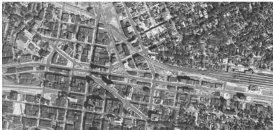
Il. 9. Syracuse. Przebieg bezkolizyjnej linii średnicowej z 1936 r., zbudowanej w miejscu wcześniej istniejącej obwodnicy naziemnej. Cornell University Library, New York State Aerial Photographs, 1938.
