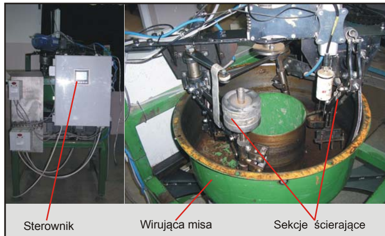
Rys. 2. Maszyna do badania zużycia w glębowej masie ściernej
