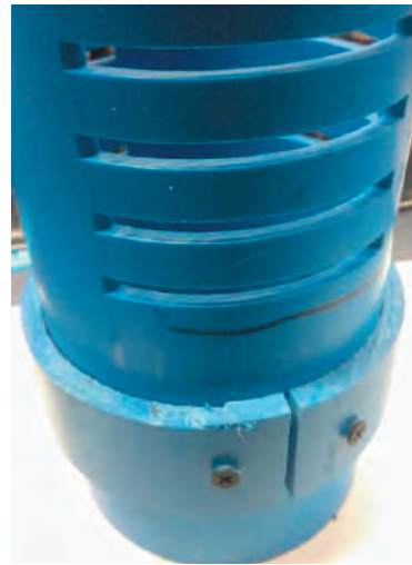
Rys. 10. System mocowania okładziny żwirowo-żywiczej za pomocą opaski z wkrętami Fig. 10. The gravel pack screen fasten by screw inside out
