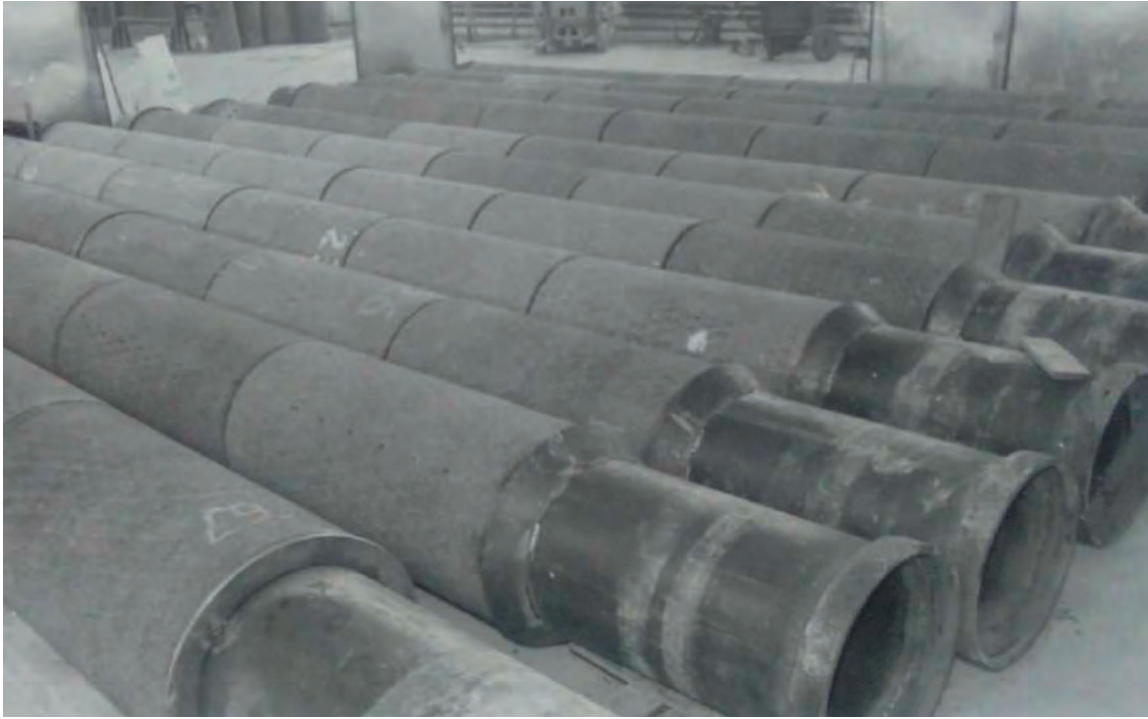
Rys. 8. Pierścienie stalowe dospawane do rury stalowej Fig. 8. A steel rings welded to perforated steel pipes
