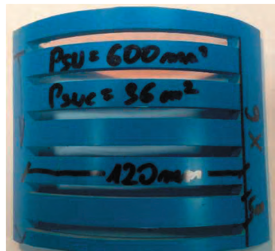
Rys. 7. Wycinek rury DN150 o wymiarach 10 x 10 cm, szerokość szczeliny SW = 5 mm Fig. 7. The sample of PVC pipe DN150, dimension 10 x 10 cm, perforation SW = 5 mm
