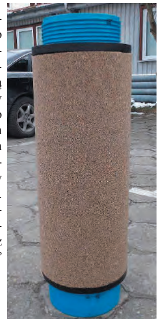
Rys. 12. Wytworzony, prototypowy system mocowania okładziny żwirowo-żywiczej Fig. 12. The real prototype of the new way fastening system without screws
