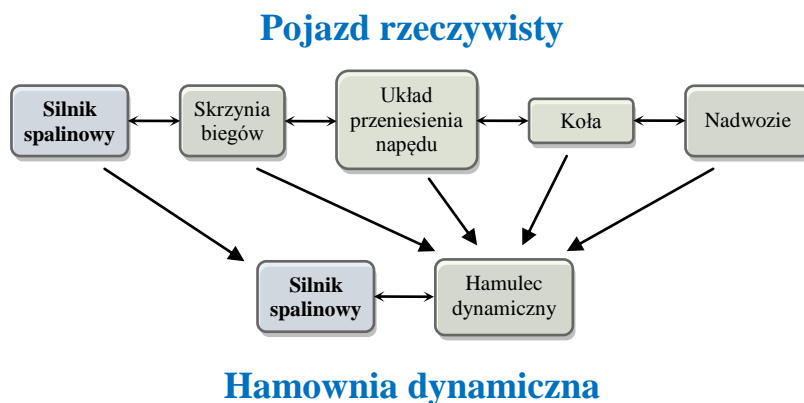
Rys. 2. Schemat ideowy działania hamowni dynamicznej [2]
