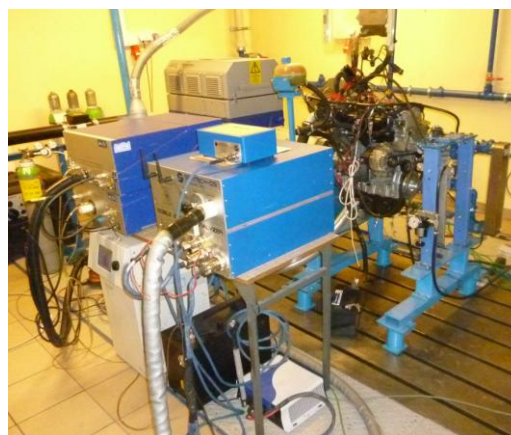
Rys. 5. Widok stanowiska badawczego podczas odzwierciedlania rzeczywistego przejazdu
