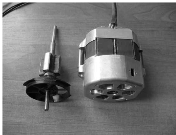
Rys.3. Widok modelu silnika z nowymi tarczami łożyskowymi i zdemonstrowanym wirnikiem
