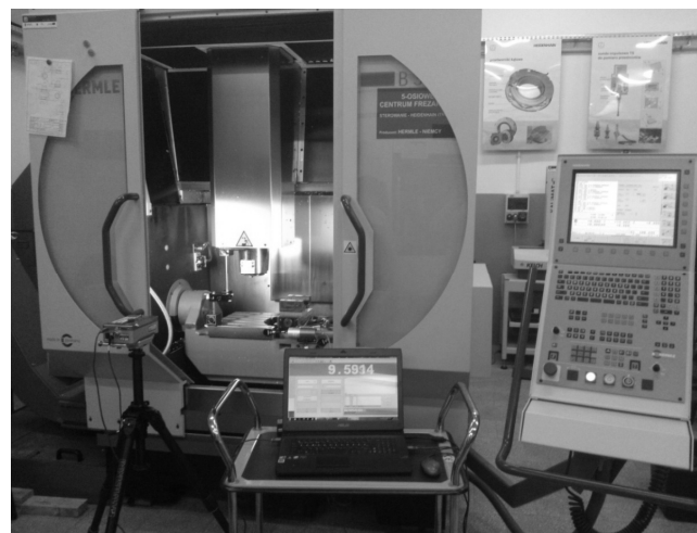
Rys. 1. Stanowisko do pomiaru dokładności pozycjonowania za pomocą interferometru laserowego XL-80
