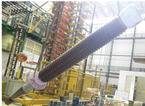
Rys. 4. Izolator przepustowy GN na stanowisku pomiarowym, kąt zawieszenia izolatora jak w transformatorze (zdjęcie własne)
