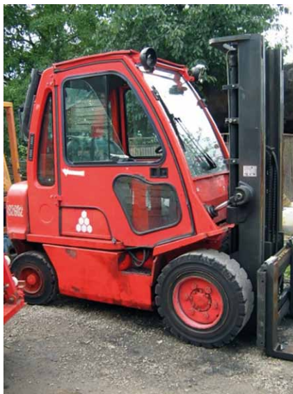
Fot. 4. W pełni obudowana kabina operatora
