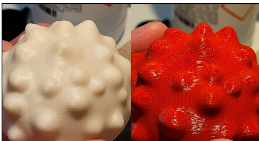
Rys.4. Porównanie tej samej faktury wydrukowanej w technologii SLA (lewa) i FDM (prawa).
