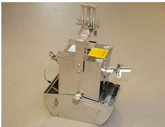
Fig. 2. Ekman's grab [photo http://www.biomm.pl/oferta/czerpacze-dna-ekman-i-lenz#&gid=1&pid=1 ].
