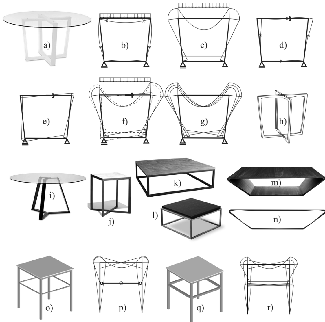
Ryc. 8. Stoły ramowe: a) widok, źródło: http://www.sklep.meble.pl/p58945.stol-domus-152.html , b-c) linia ugięcia i wykres momentów stołu z ryc. 8a od pionowego obciążenia, d-e) linia ugięcia i wykres momentów stołu z ryc. 8a od poziomego obciążenia, f) wykres momentów stołu z ryc. 8a od obu obciążeń, g) obwiednia momentów stołu z ryc. 8a, h) forma stołu z ryc. 8a wynikająca z pracy konstrukcji, i) widok, źródło: http://www.sklep.meble.pl/p73134.wloski-stol-archie-152.html , j) widok, projekt Marc Krusin, źródło: http://hivemodern.com/pages/product5753/knoll-marc-krusin-side-table-table , k) widok, źródło: http://www.houzz.com/photos/coffee-tables/ , l) widok, źródło: http://www.furniturefashion.com/2008/06/02/drake_classic_modern_coffee_table.html , m) widok, projekt Eero Koivisto i Ola Rune, źródło: http://www.moderndesigninterior.com/2006_03_01_archive.html , n) zmiana grubości płyty stołu z ryc. 8m wynikająca z pracy konstrukcji, o) stół z cienkimi łączynami, p) obwiednia momentów stołu z ryc. 8o, q) stół z łączynami połączonymi sztywno z nogami, r) obwiednia momentów stołu z ryc. 8q. Rys. autorka
