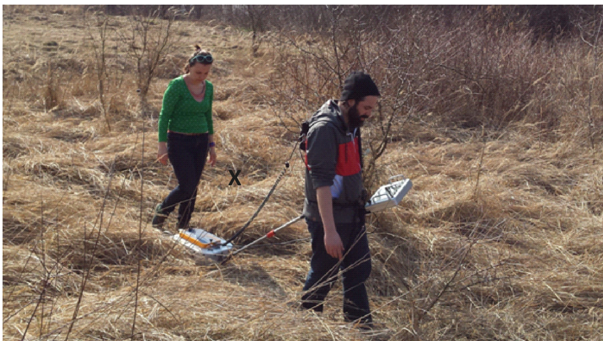
Fig. 6. MALÅ RAMAC X3M ground-penetrating radar research at area A – Jewish cemetery in Rejowiec. Ryc. 6. Badania terenowe georadarem MALÅ RAMAC X3M na terenie cmentarza żydowskiego w Rejowcu.
