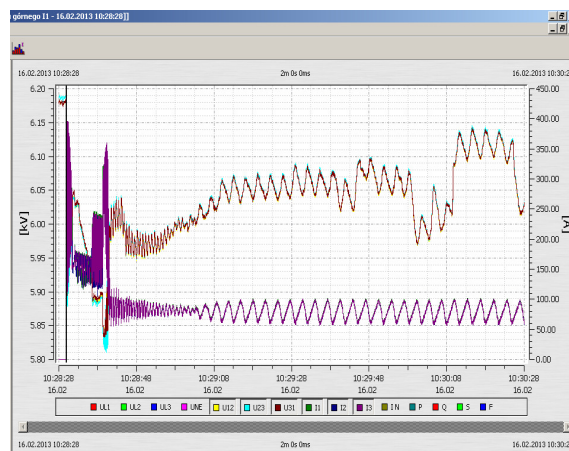
Rys. 3. Rozruch silnika SAS 630kW MK-152 – 9 stopni kaskada oporowa
