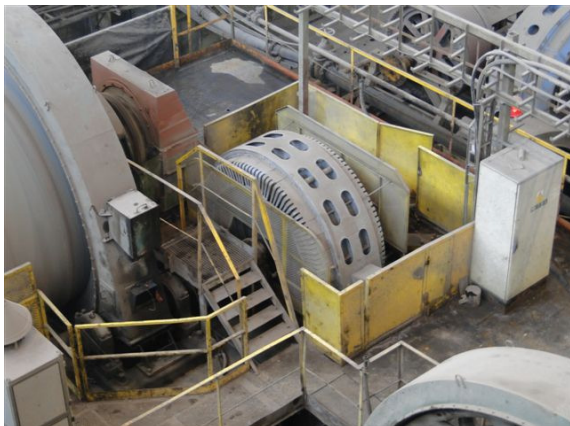
Rys. 1. Silnik napędu młyna bębnowego w otoczeniu urządzeń technologicznych
