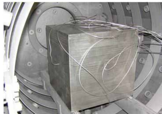
Rys.3. Próba szybkości chłodzenia wg NADCA na referencyjnym bloku stalowym o wymiarach 400/400/400 mm.
