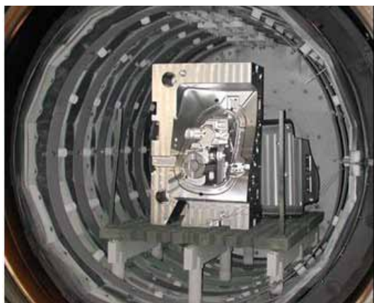
Rys.4. Matryca w komorze pieca próżniowego po kompleksowej obróbce cieplnej.
