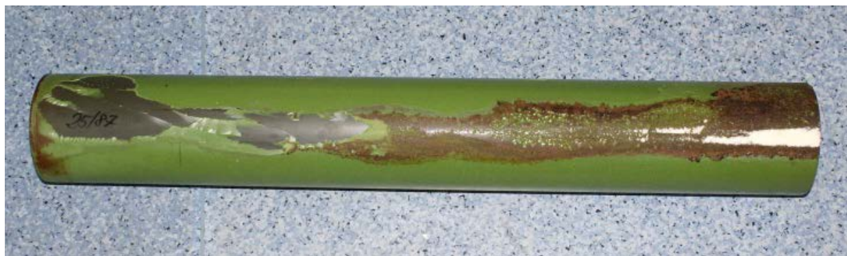
Zdjęcie 12. Odklejony/oderwany inhibitor ziarna paliwa.
