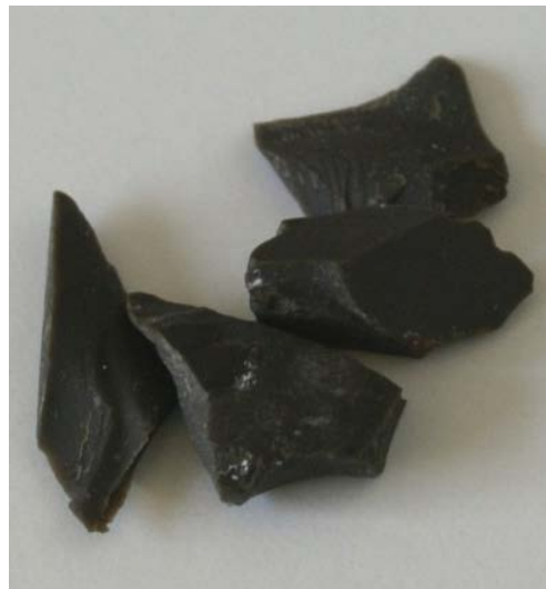
Zdjęcie 8-9. Pęknięta obejma silnika oraz niespalone kawałki paliwa
