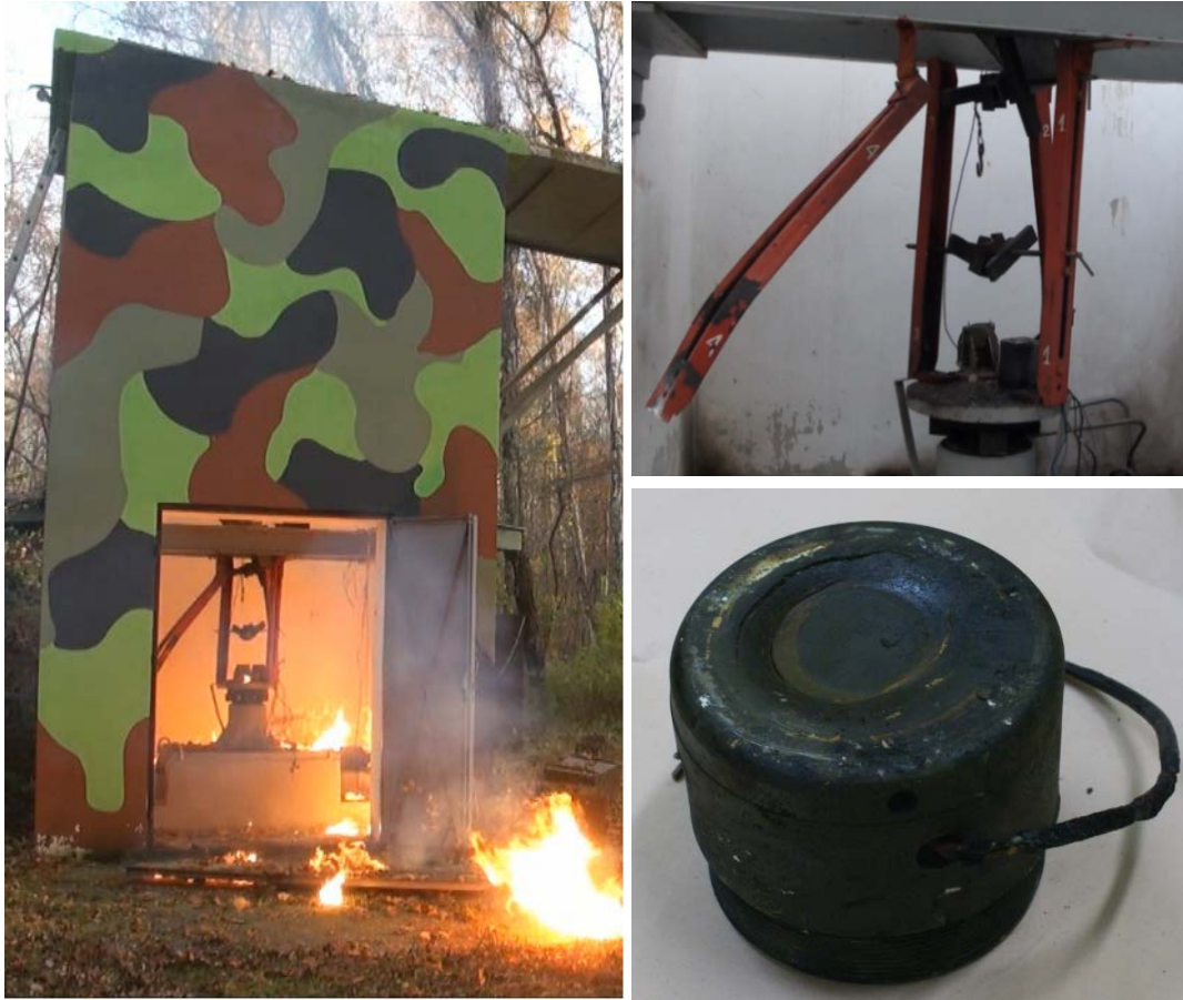
Zdjęcia 3-5. Zniszczone stanowisko badawcze oraz dno silnika
