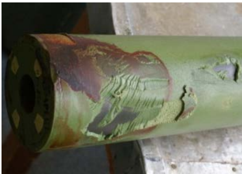
Zdjęcie 13. Oderwany inhibitor ziarna paliwa.
