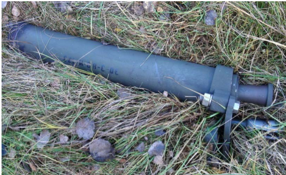
Zdjęcie 6 i 7. Pozostałości korpusu silnika, który został zniszczony podczas badań
