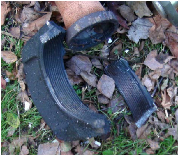
Zdjęcie 8-9. Pęknięta obejma silnika oraz niespalone kawałki paliwa
