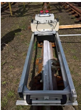
Rys. 6. Skaner 3D Skorpion – nowa iglica w Track Tec KolTram Zawadzkie (kwiecień 2016 r.)
