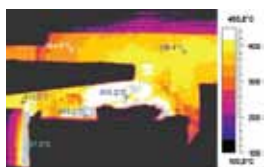
Rys. 5. Porównanie rozkładów temperatury na zewnętrznej powierzchni bloku palisady basenu na poziomie lustra szkła w strefie klarowania dla ściany czołowej przy przepieście dla wanny U-płomiennej w różnych okresach eksploatacji
