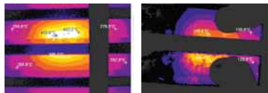
Rys. 10. Rozkłady temperatury na zewnętrznej powierzchni trzonu pieca szklarskiego do produkcji szkła opakowaniowego w zagrożonym obszarze dna w części topienia: a) obraz termalny bezpośrednio po wykryciu przegrzania w miejscu zagrożonym; b) obraz termalny po zastosowaniu chłodzenia punktowego powietrzem; c) obraz termalny po zastosowaniu chłodzenia wodą
