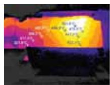
Rys. 4. Rozkłady temperatury na zewnętrznej powierzchni bocznej basenu topliwego pieca szklarskiego na ścianach bocznych, na ścianie czołowej i na blokach naróżnych przy kieszeni zasypowej (z poziomu hali technologicznej)
