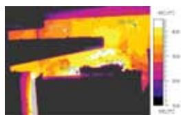
Rys. 5. Porównanie rozkładów temperatury na zewnętrznej powierzchni bloku palisady basenu na poziomie lustra szkła w strefie klarowania dla ściany czołowej przy przepieście dla wanny U-płomiennej w różnych okresach eksploatacji
