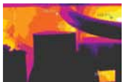
Rys. 5. Porównanie rozkładów temperatury na zewnętrznej powierzchni bloku palisady basenu na poziomie lustra szkła w strefie klarowania dla ściany czołowej przy przepieście dla wanny U-płomiennej w różnych okresach eksploatacji
