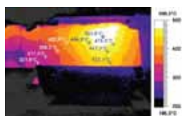
Rys. 5. Porównanie rozkładów temperatury na zewnętrznej powierzchni bloku palisady basenu na poziomie lustra szkła w strefie klarowania dla ściany czołowej przy przepieście dla wanny U-płomiennej w różnych okresach eksploatacji
