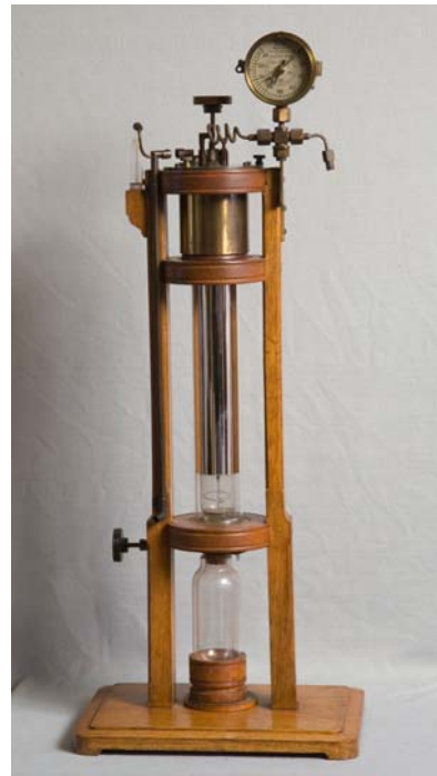
Ryc. 2. a) Strona tytułowa prospektu reklamowego aparatów oferowanych przez Grodzickiego, Drukarnia Uniwersytecka, Kraków, po 1908 r. b) Aparat do skraplania powietrza i wodoru, nr inw. MUJ 4458, 469/V (źródło: Muzeum UJ, fot. J. Kozina).
