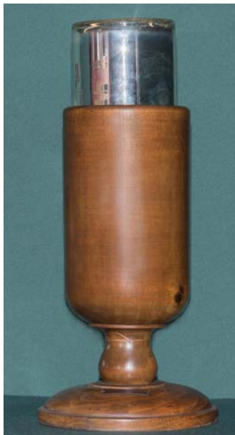
Ryc. 12. Naczynie dwuścienne do prac ze skraplanymi gazami, Mieczysław Szymański, Lwów, 1921–1939 (źródło: Muzeum UJ, nr inv. MUJ 16671, 1967/V, fot. J. Kozina).
