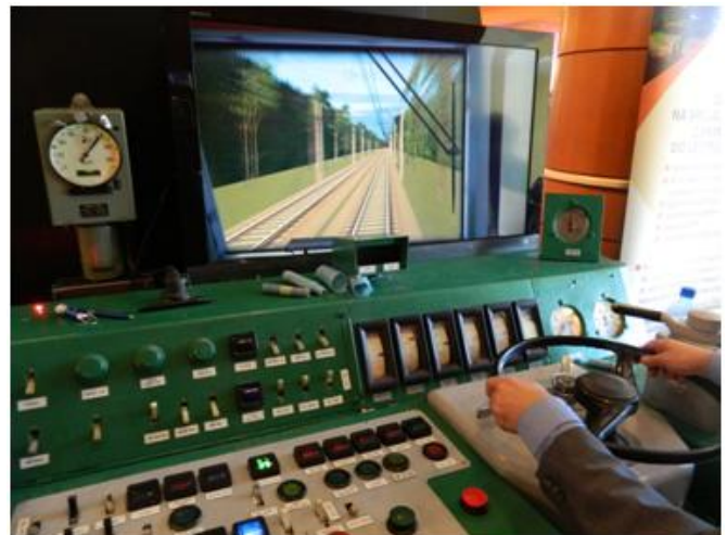
Rys. 7. Widok stanowiska szkoleniowego z pulpitem lokomotywy ET22 (opracowanie własne)
