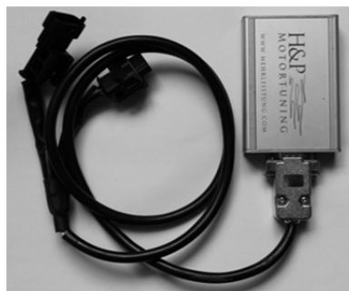
Rys. 6. Klasyczny box wykorzystany dla silnika Fiat 1.3 JTD
