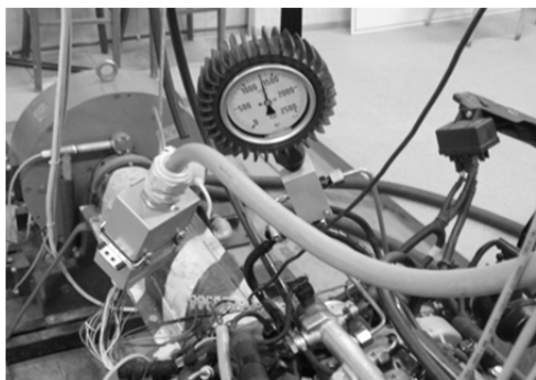
Rys. 3. Manometr do badania wysokiego ciśnienia Common Rail na silniku FIAT 1.3JTD
