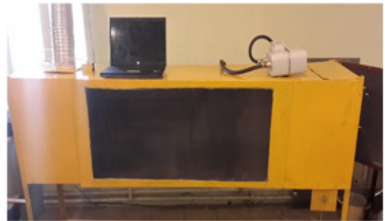
Рис. 2. Экспериментальная установка для определения огнетушащей эффективности ударной волны. 1. Люк для тигля; 2. Вентиляционное отверстие с вентилятором и защелкой; 3. Тигель; 4. Люк; 5. Генератор ударных волн; 6. Крепление генератора ударных волн; 7. Измеритель давления УВ; 8. Стойки; 9. Электровоспламенитель; 10. Смотровое окно
