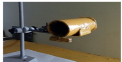
Рис. 3. Генератор ударных волн 1. Корпус генератора ударных волн; 2. Электровоспламенитель; 3. Пороховой заряд; 4. Направление движения ударных волн
