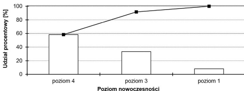
Rys. 2. Struktura poziomu nowoczesności części podzespołów prasy próżniowej wykorzystywanej w procesie wytwarzania cegły ceramicznej
