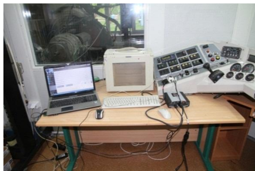
Rys. 3. Stanowisko dynamometryczne do badań zespołów napędowych KTO Rosomak: a) widok silnika ze skrzynią biegów, w tle po prawej stronie widoczna kabina sterownicza, b) diagnostyk Texa wraz z komputerem pomiarowym i pulpitem kierowcy KTO Rosomak
