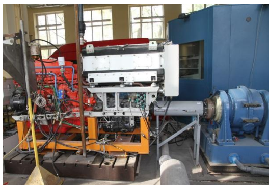
Rys. 3. Stanowisko dynamometryczne do badań zespołów napędowych KTO Rosomak: a) widok silnika ze skrzynią biegów, w tle po prawej stronie widoczna kabina sterownicza, b) diagnostyk Texa wraz z komputerem pomiarowym i pulpitem kierowcy KTO Rosomak
