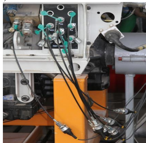
Rys. 7. Pomiary ciśnienia w skrzyni biegów a) złącza przyłączeniowe czujników, b) widok czujników wraz ze złączami przyłączeniowymi
