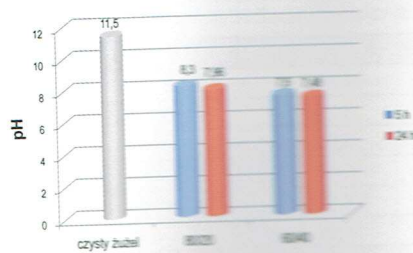
Rys. 3. Zmiany wartości pH wody po przeprowadzonym procesie gotowania kompozytów w zależności od udziału żużla i włókna szklanego oraz czasu procesu spiekania, w odniesieniu do pH wody oznaczonej dla czystego żużla
