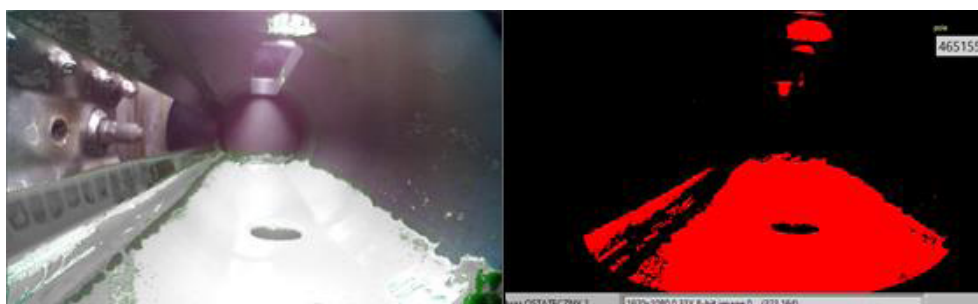
Rys. 9. (lewa)Przekształcone zdjęcie dla oddania bieli (prawa) Rozpoznawanie barwy białej na zdjęciu preparowanym; Fig. 9. (left) Photo transformed to emulate white paint stains (right) White color recognition on transformed photo; Źródło: opracowanie własne
