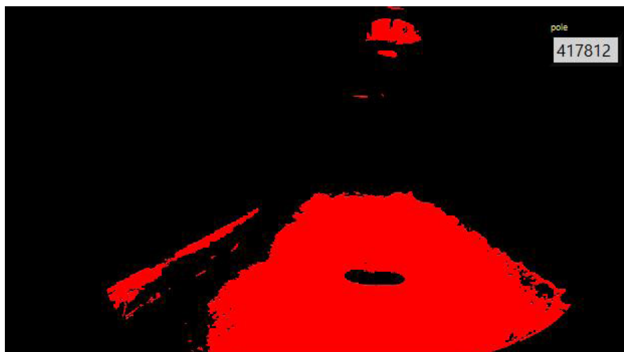
Rys. 10. Rozpoznawanie barwy białej na zdjęciu preparowanym z ograniczonym zakresem, uznawanym za biel; Fig. 10. White color recognition on transformed photo with limited range of pixel values being treated as white; Źródło: opracowanie własne
