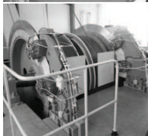
Rys. 7. Maszyna wyciągowa BB-2500/AC-4m/s [źródło: własne]
