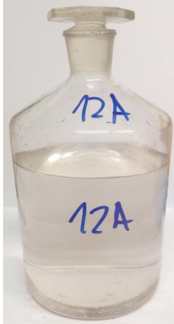
Rys. 6. Woda termalna 24 godziny po dozowaniu kwas askorbinowego w ilości 1g/l, w której doszło do rozpuszczenia osadów (fot. Marcin Mazur)
