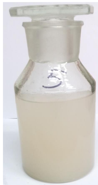
Rys. 4. Woda termalna 15 minut po dodaniu fosforanu sodu w ilości 0,25 g/1 litr solanki (fot. Marcin Mazur)
