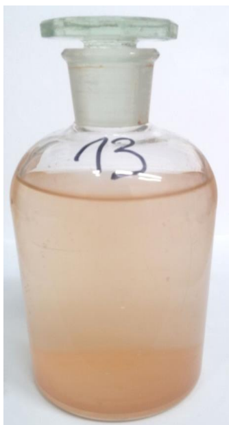
Rys. 2. Woda termalna pozostawiona na 24 h bez dodatku środka kondycjonującego (fot. Marcin Mazur)
