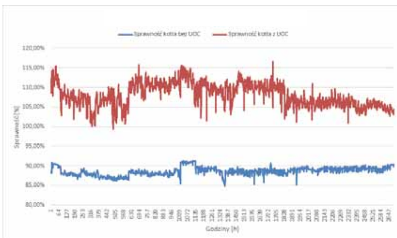
Rys. 9. Sprawność kotła K6 z instalacją odzysku ciepła oraz bez instalacji
