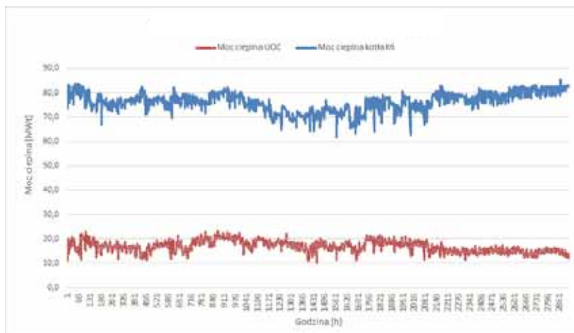
Rys. 8. Moc cieplna układu odzysku ciepła w porównaniu do mocy cieplnej kotła
