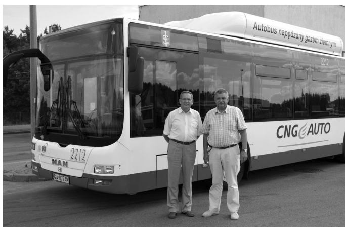
Fot. 6. Prezes PKM w Gdyni Kazimierz Gałkiewicz (z lewej) z autorem (L.K.) przy autobusie MAN CNG. Na dachu pojazdu umieszczono lekkie, kompozytowe butle na gaz produkcji amerykańskiej
