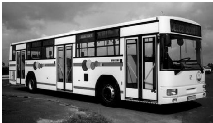
Fot. 1. Jelcz 120M CNG. Instalowano od 8 do 10 zbiorników na paliwo umieszczonych pod podłogą przedziału pasażerskiego (Infobus)
