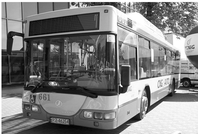
Fot. 4. Jelcz 125M/4 CNG. Na dachu tego modelu znajdują się 4 kompozytowe zbiorniki CNG (PKM Tychy)
