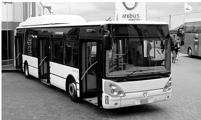
Fot. 2 Irisbus Citelis 12 M CNG. Na dachu umieszczono 10 sztuk butli z gazem o pojemności 155 l każda (fot. J. Jackiewicz)
