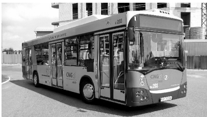
Fot. 3. Jelcz M121M/4 CNG. Na dachu autobusu znajdują się 4 kompozytowe zbiorniki paliwa, które zostały wkomponowane w konstrukcję dachu i częściowo wnikają do wnętrza pojazdu. Dzięki takiemu rozwiązaniu udało się zmniejszyć wysokość autobusu oraz poprawić jego właściwości jezdne (fot. Anna Serkis)
