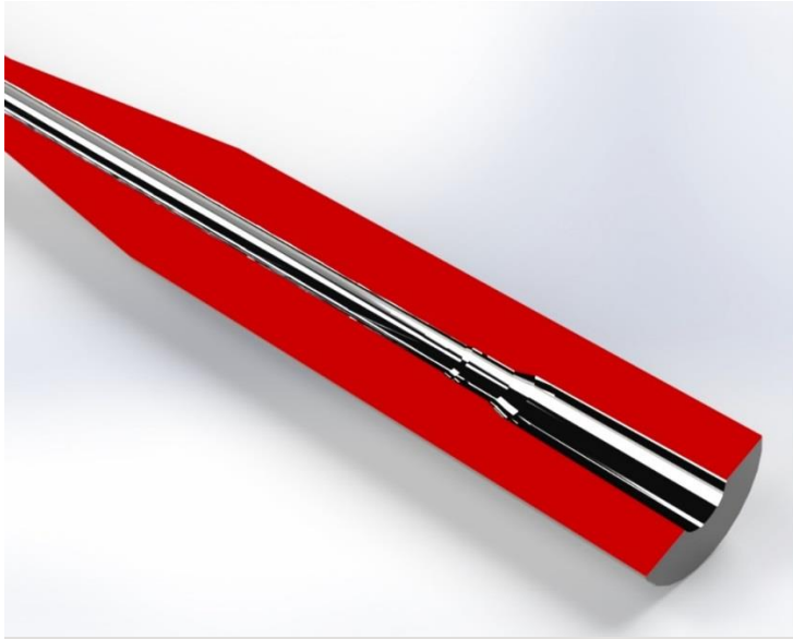
Rys. 5.6. Wizualizacja przekroju poprzecznego na długości komory naboju dla lufy niewzmocnionej 12,7x99 NATO
