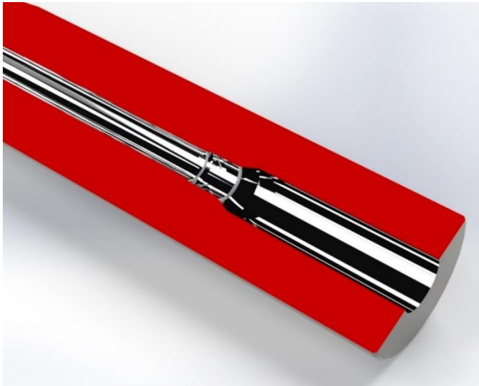
Rys. 5.2. Wizualizacja przekroju poprzecznego na długości komory naboju dla lufy niewzmocnionej 5,56x45
