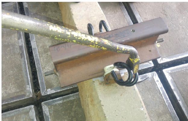
Rys. 2. Widok stanowiska do badania wytrzymałości montażowej łapki sprężystej SB4 [fot. autorzy]
