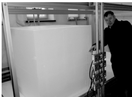
Rys. 4. Blok styropianu EPS podczas obróbki na stanowisku cięcia wielodrutowym ploterem termicznym
