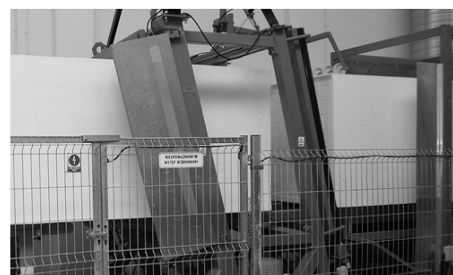
Rys. 3. Blok styropianu EPS podczas obróbki na stanowisku cięcia potokowego
