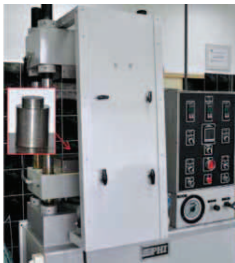
Rys. 4. Prasa hydrauliczna wraz z cylindryczną komorą wytrzymałościową znajdującą się w INiG-PIB Zakład Stymulacji Wydobywania Węglowodorów, oddział Krosno
