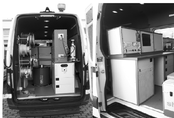
Rys. 4. Wóz pomiarowy do prób napięciowych DAC i VLF
