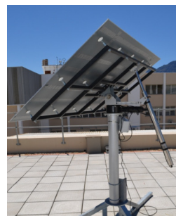
Rys. 5. Heliostat Helio 40, na podstawie [5]
