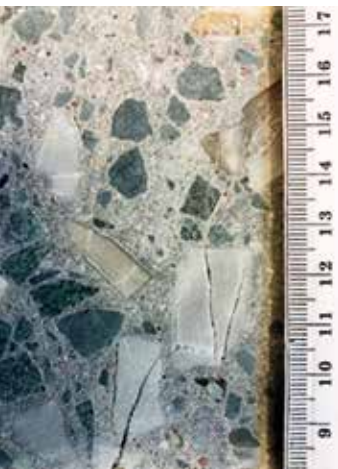
Fot. 4. Przekrój odwiertu betonowego z widocznymi spękaniami ziaren kruszywa (ale tylko jasnoszarych, ziarna ciemnoszare nie-spękałe)
