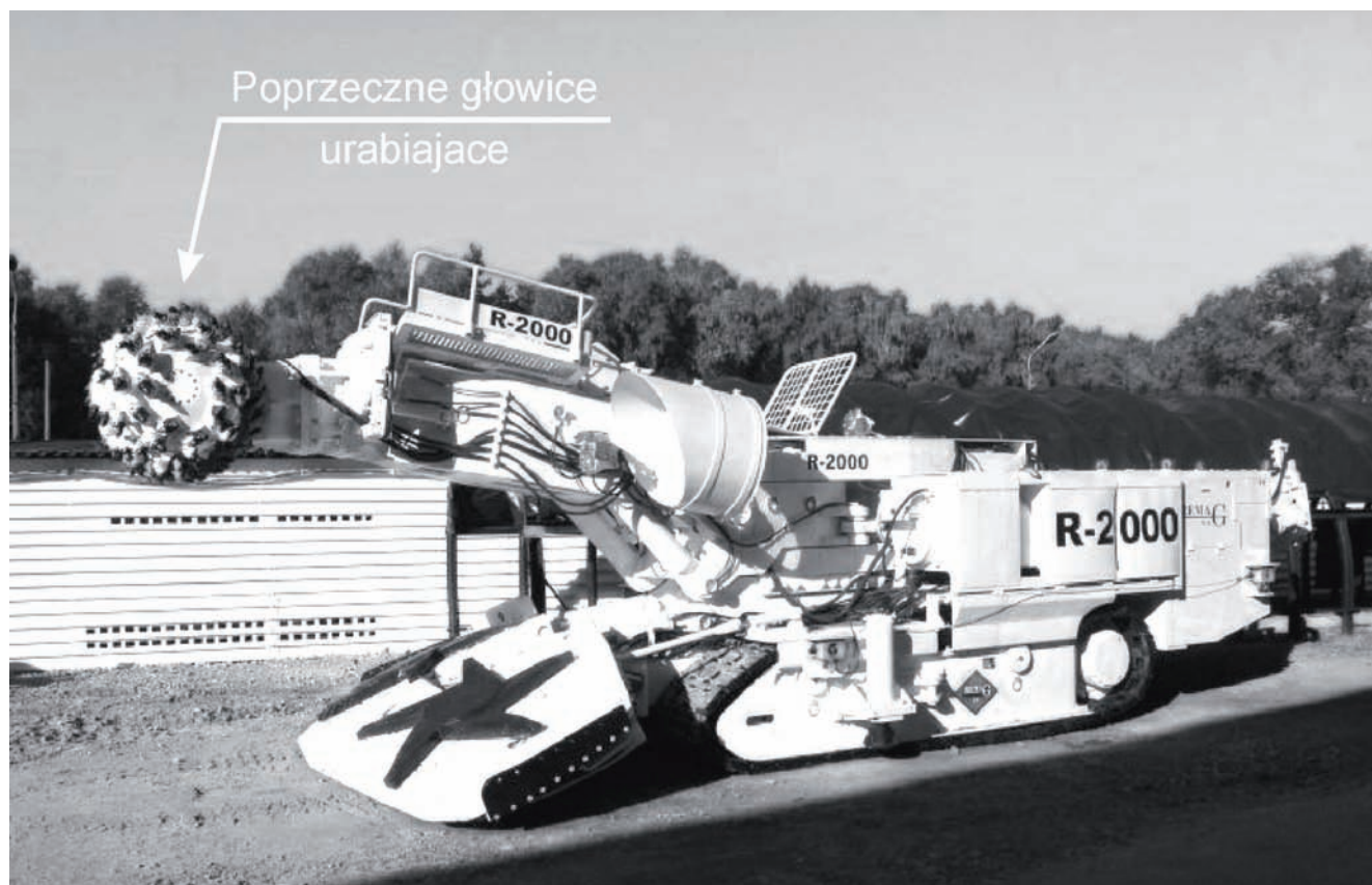
Rys. 2. Wysięgnikowy kombajn chodnikowy R-2000 (prod. Famur S.A.) wyposażony w poprzeczne głowice urabiające [3] Fig. 2. R-2000 boom-type roadheader (manufactured by Famur S.A.) with transverse cutting heads [3]
