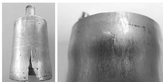
Rys. 2. Pęknięcia półwyrobów wyprasek w miejscu poszerzenia średnicy korpusu
